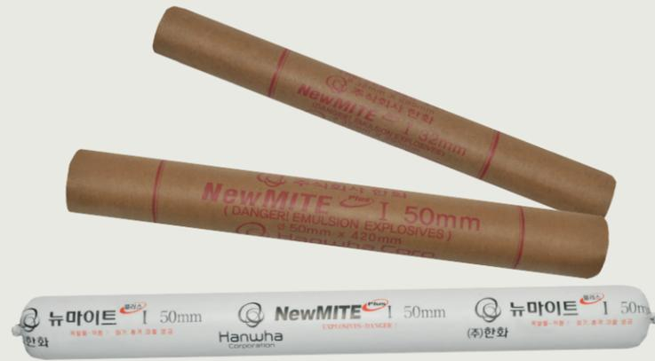
뉴마이트 플러스는 사용 및 취급이 용이하도록 당사 고유의 유화제 및 유화기술을 이용하여 약상을 딱딱하게 만들었으며 내수성 및 내한성(-20℃)이 우수합니다. 사용용도에 맞추어 지포장과 필름포장 제품을 공급하고 있으며, 특히 지포장의 경우 다이너마이트와 동등한 약상을 보유하여 수평장전이 용이한 제품입니다.
